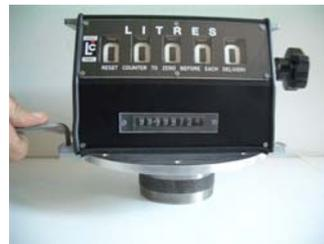
Svitare le viti M4 che uniscono il coperchio in alluminio ai fianchi pressofusi facendo in modo di presentare alla vista il totalizzatore con i suoi particolari interni pronto per essere pulito ingrassato e lubrificato.
